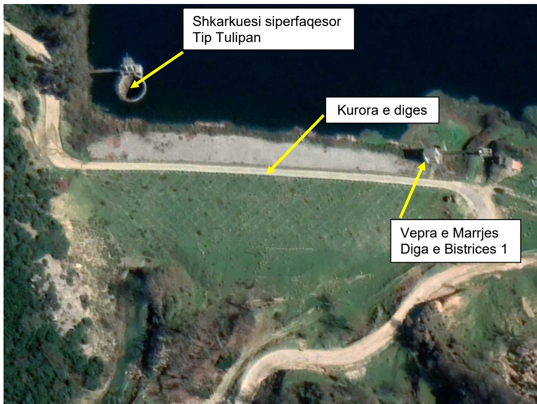
Figure 3-1 Planimetria e digës se Bistrices 1 dhe shkarkuesi siperfaqesor
